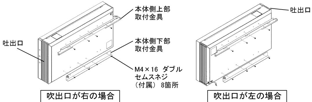
4. 壁面取付金具を壁面に固定する。
